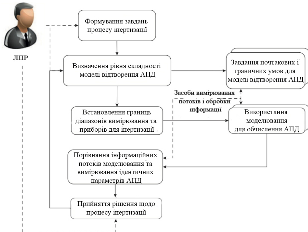
Рисунок 2 Схема реалізації методу підтримки прийняття рішень при інертизації вантажних трюмів танкерів
