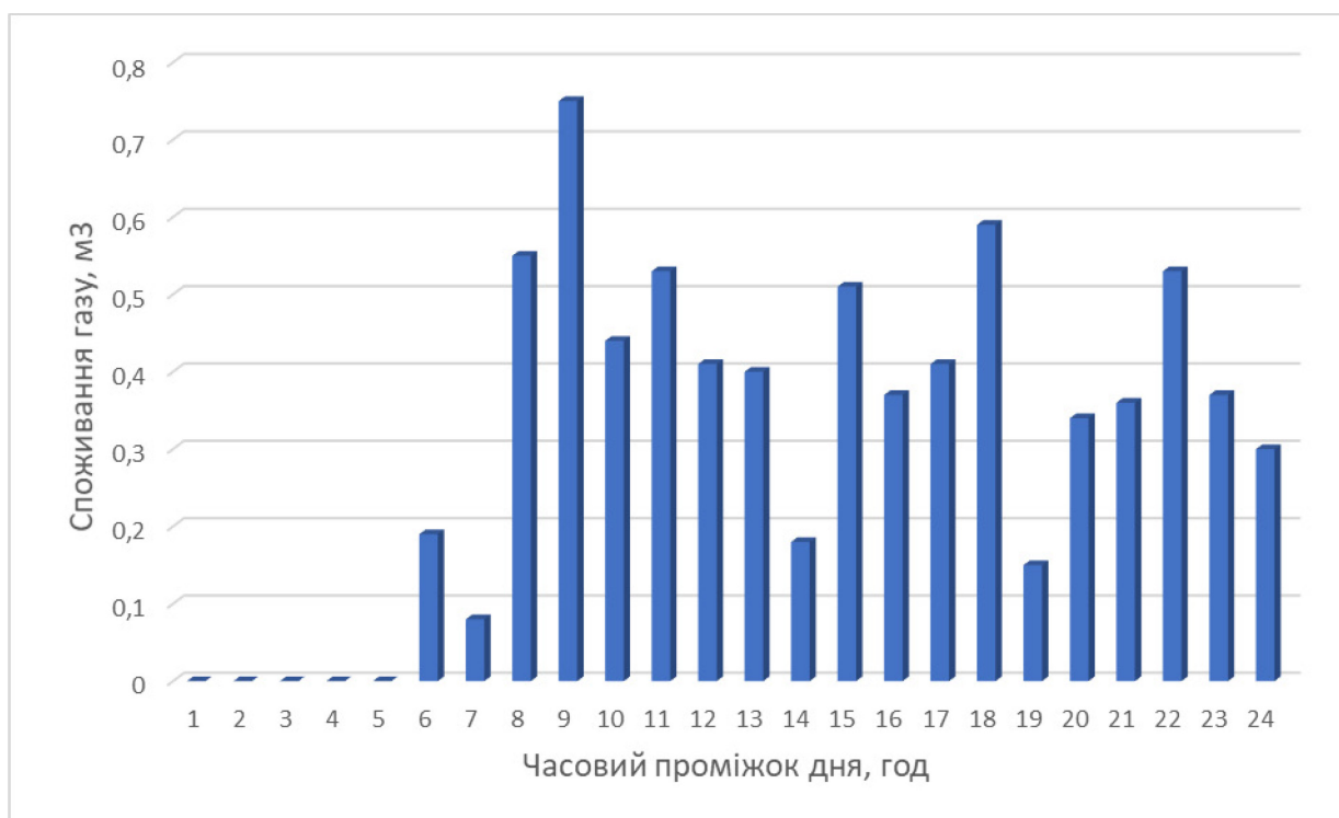
Рисунок 4.34 – Графік споживання газу котлом впродовж доби котедж в м. Львів будній день температура зовнішнього повітря від -9 до -4 °С.
