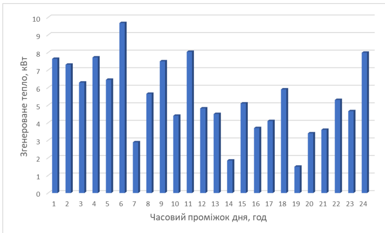
Рисунок 4.31 – Графік генерації тепла впродовж доби котедж в м. Львів будній день температура зовнішнього повітря від -9 до -4 °С
