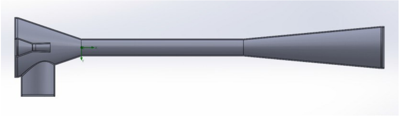
Рисунок 2.3 – Модель ежектору, спроектованого на протитиск 1,35 бар
