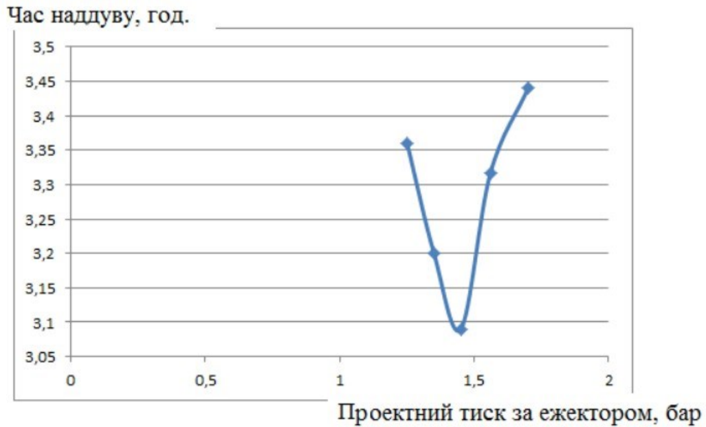
Рисунок 2.1 - Залежність часу, необхідного для нагнітання повітря у ГО до 1,72 бар, від проектного тиску за ежектором
