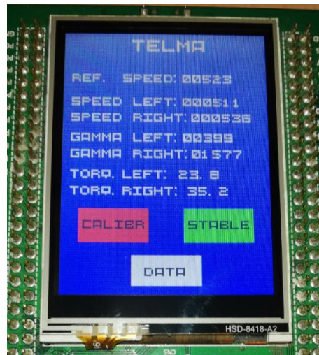
Рис. 4.14. Зображення інтерфейсу для керування індукційними гальмами
