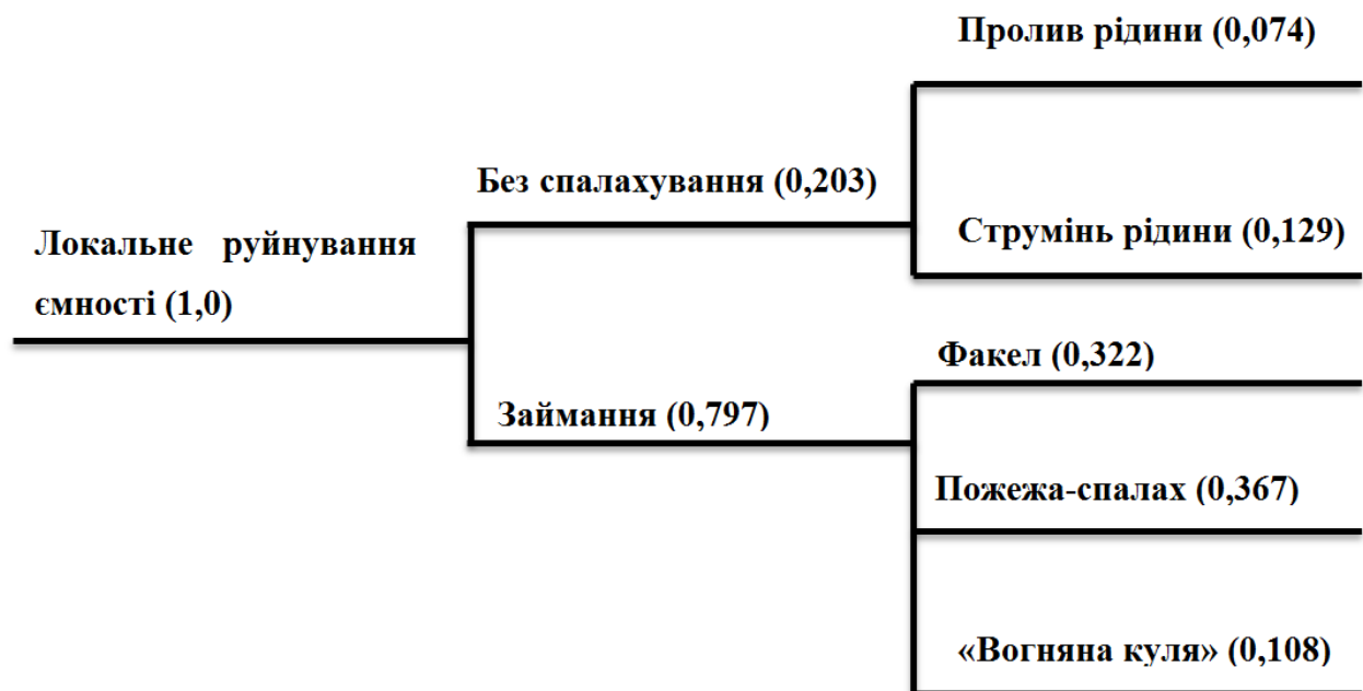
Рис. 2.1 – Аналіз розвитку НС на АЗС внаслідок руйнування ємності за допомогою «дерева подій» [20, 71]
