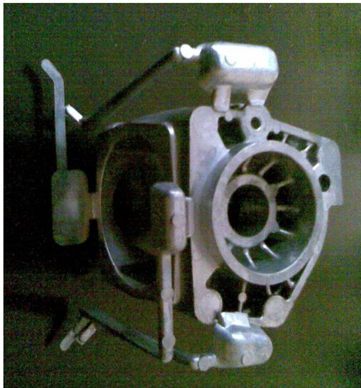
Рис. 5.1 Корпус насоса, отриманий за новою технологією
