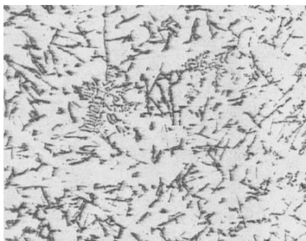
Рис. 3.18 Вплив тиску на мікроструктуру сплаву АК7ч:
