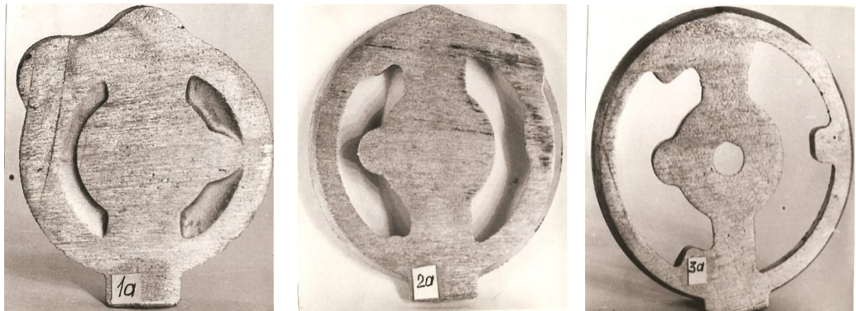
Рис. 3.10 Перетин виливків при центральному підводі металу:
