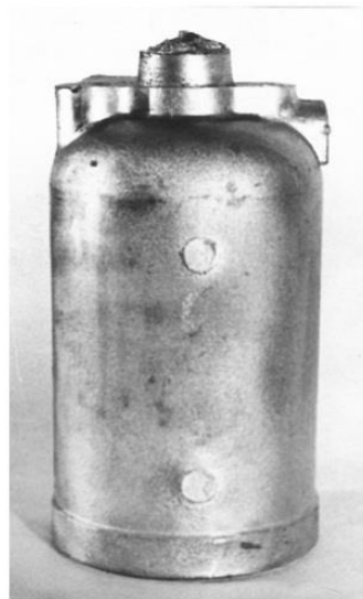
Рис.3.8 Виливок деталі "Корпус фільтра", отриманий литтям під низьким тиском по новій технології
