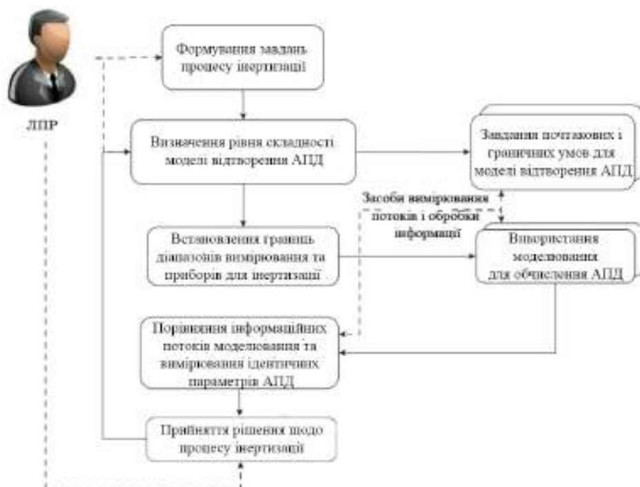
Рисунок 2 Схема реалізації методу підтримки прийняття рішень при інертизації вантажних трюмів танкерів
