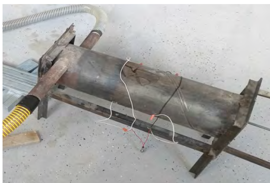
Рис.4.7. Топка жаротрубного котла для вогневих випробувань з тангенціальним підведенням повітря і осьовим підведенням палива
