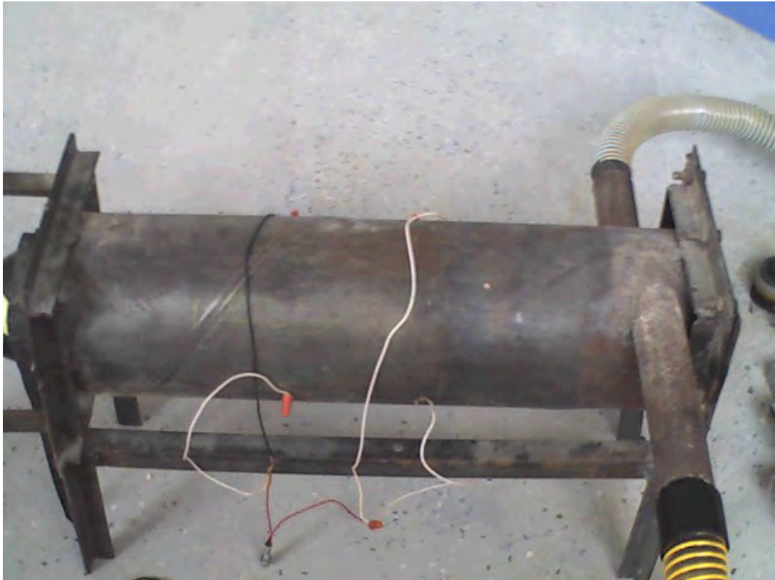
Рис.Б.1. Фотографія дослідного зразка топки.
