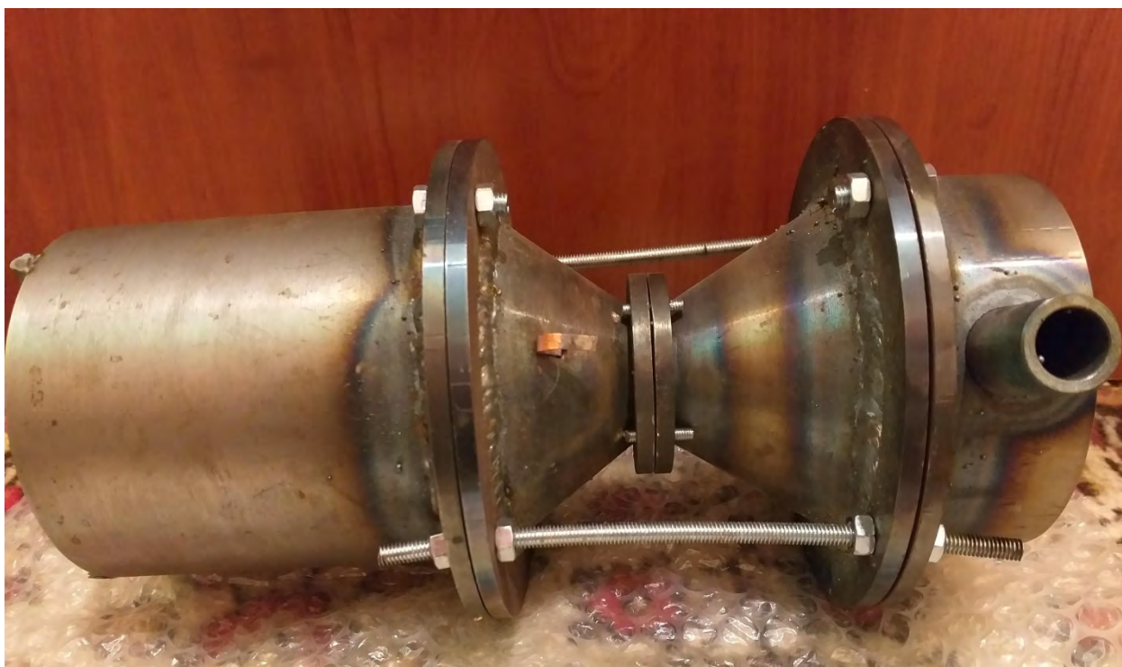
Рис. 4.11. Фотографія дослідного зразка пальника.
