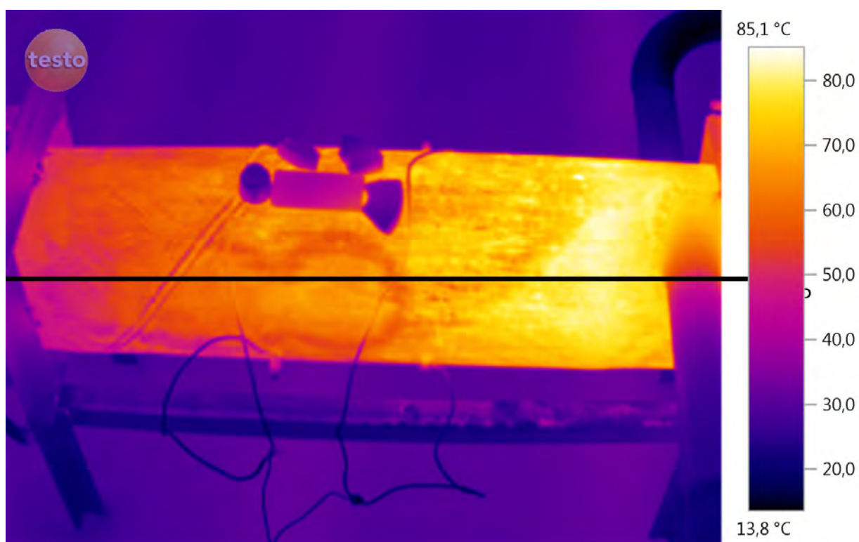
Рис.Б.10. Термографія топки. Від початку роботи пальника – 3 хв.
