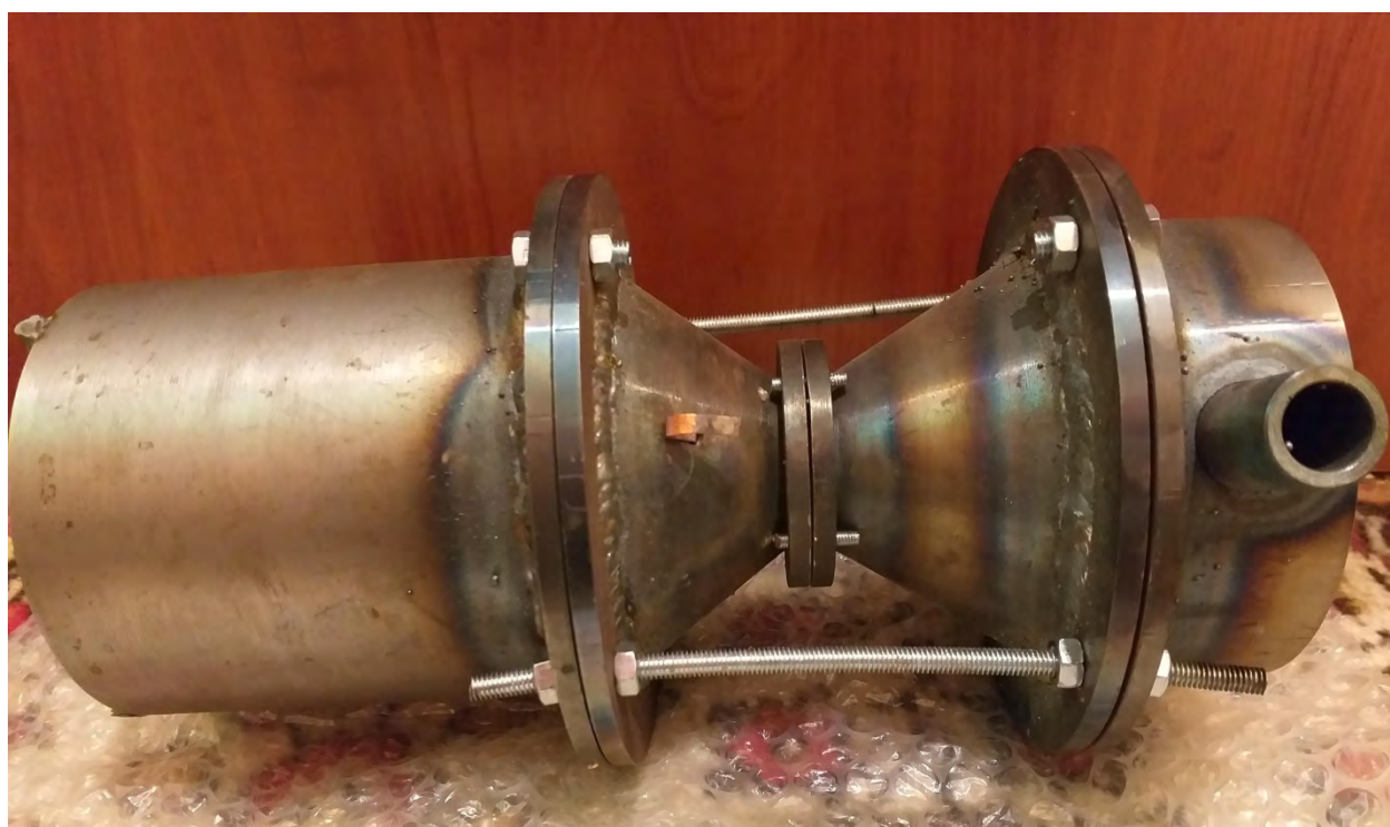
Рис.А.4. Фотографія дослідного зразка пальника.
