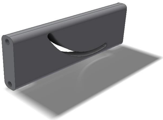
Рисунок 4.14 – Напрямна пластина з криволінійним пазом визначає стабілізацію тиску (пластина P4);
