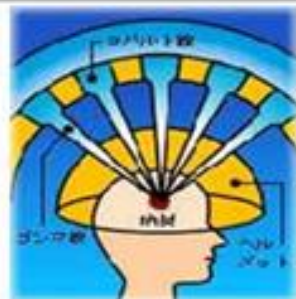
Схема вращения и фокусирования аппарата «Гамма-нож»
